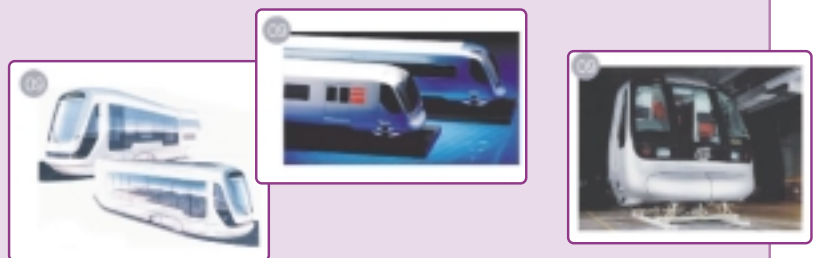
Diseño final del STIB Tramway 2000. A menudo se crean modelos a escala o maquetas a tamaño natural para mostrar el diseño en 3D (modelo a escala y maqueta de los trenes de línea MTRC – TCL).
